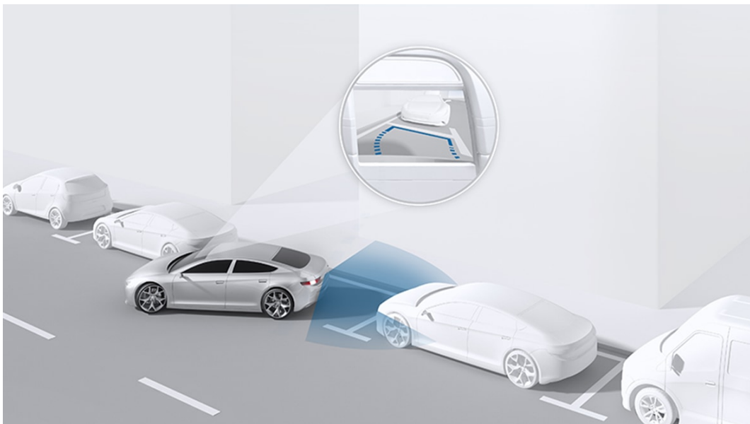
Figura 1.2: Azione di una retrocamera con riscontro visivo sul monitor
