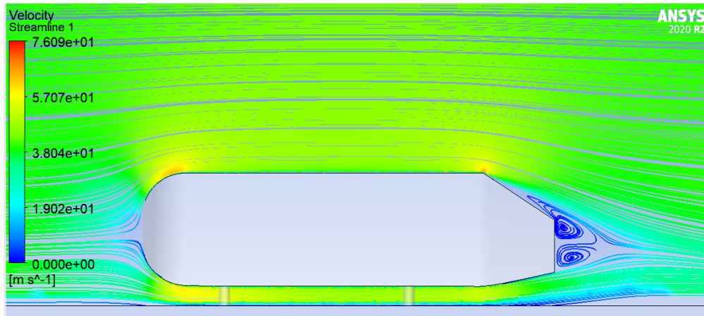
Figura 8.91: Streamlines velocità valutate sul piano di simmetria della geometria ottimizzata tramite AP
