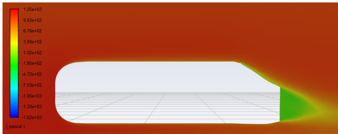
Figura 8.97: Pressione totale valutata sul piano di simmetria della geometria ottimizzata tramite AS2
