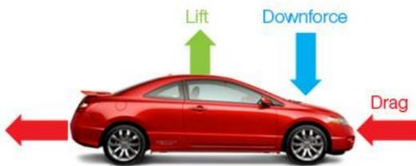
Figura 3.6: Forze aerodinamiche su un veicolo
