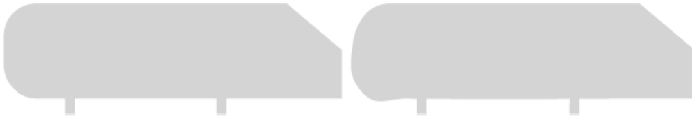
Figura 7.7: Confronto tra baseline (sinistra) e forma ottimizzata (a destra)
