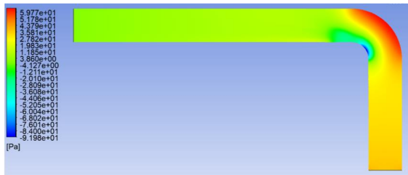
Figura 8.52: Pressione statica valutata sul piano di simmetria della mesh iniziale fitta
