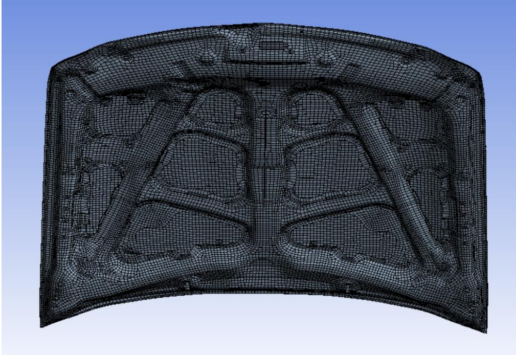
Figura 70 Cofano ottenuto con la seconda ottimizzazione
