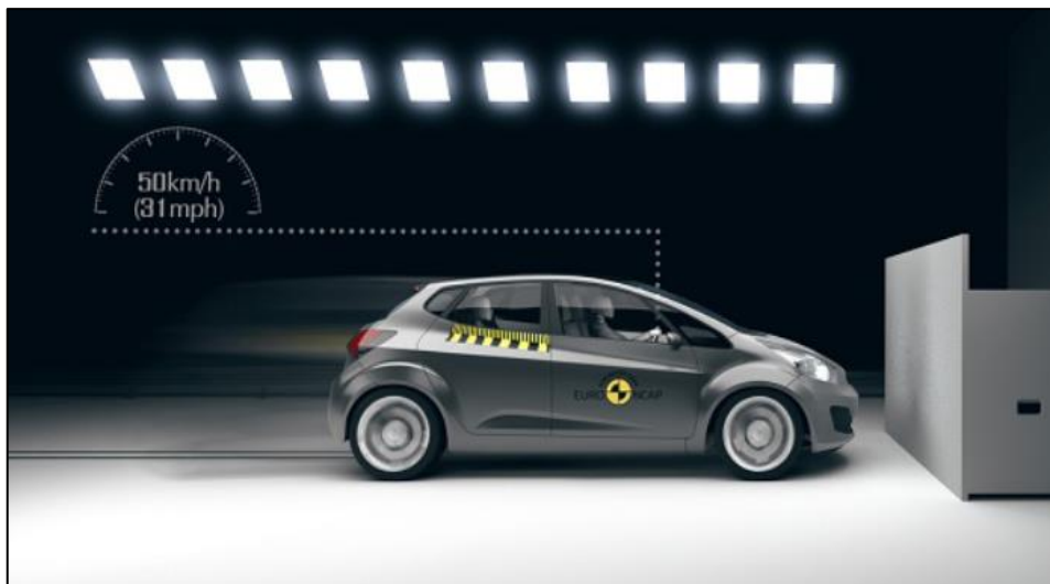
Figura 18 - Test con barriera rigida a tutta larghezza
