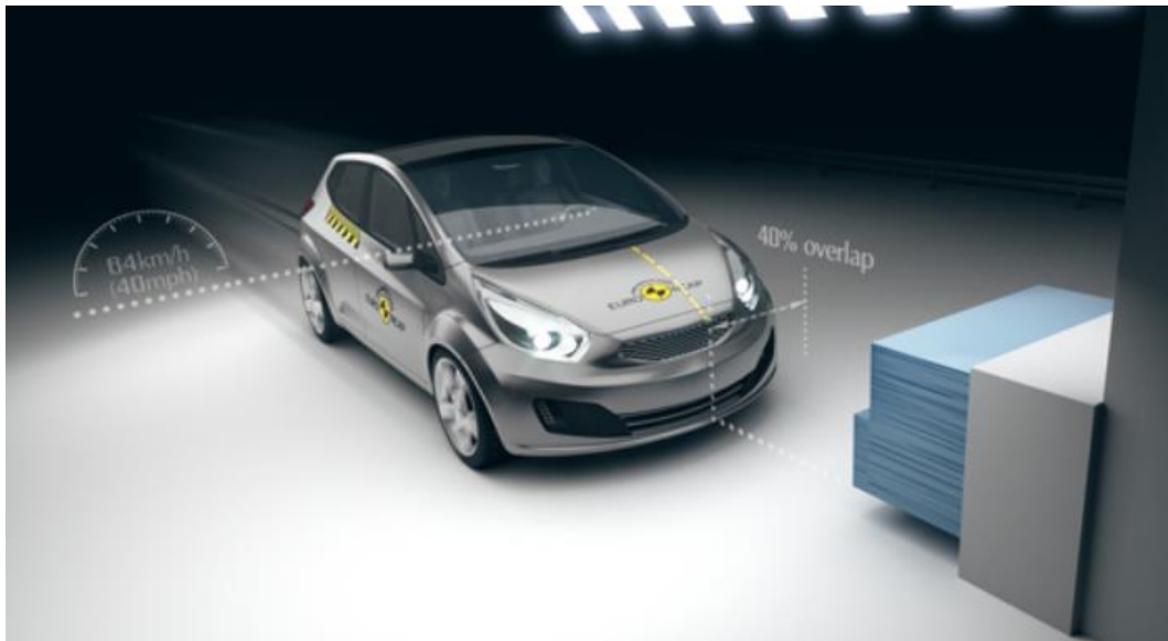
Figura 22 – Test Barriera deformabile disassata
