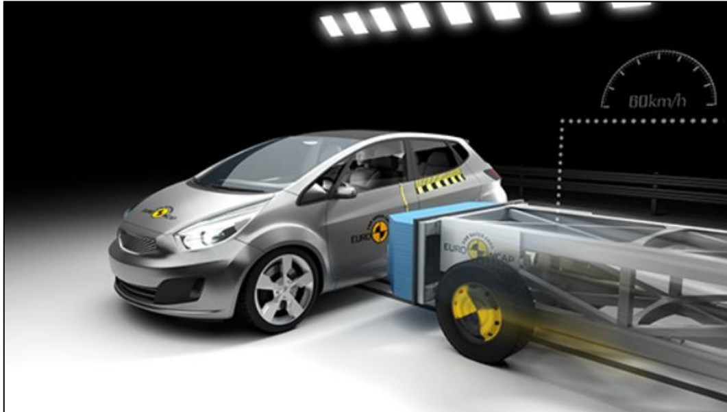
Figura 19 – Test barriera mobile laterale
