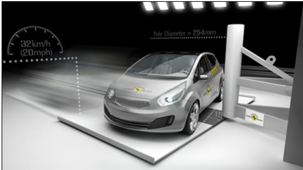
Figura 20 - Test del palo
