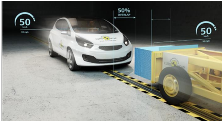
Figura 17 - Test a Barriera mobile con elemento deformabile progressivo
