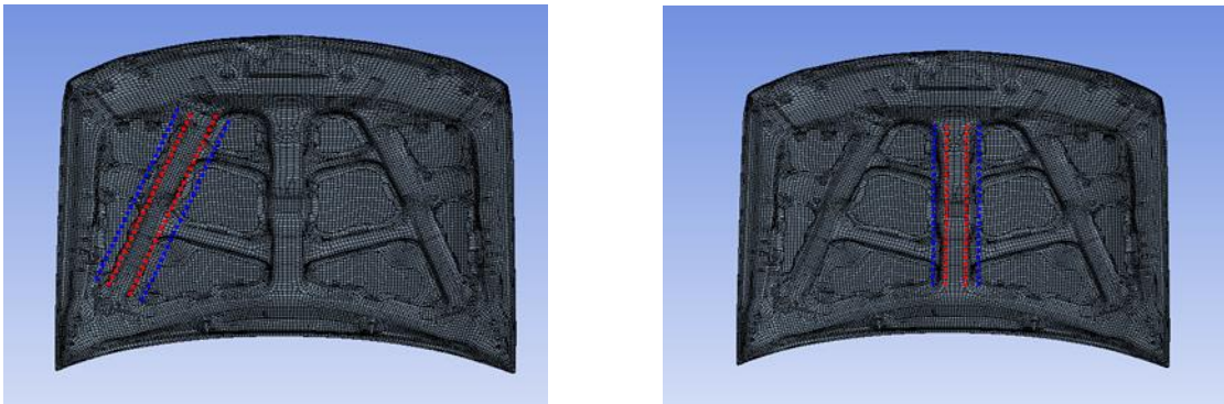
Figura 61 Curve offset applicato per ottimizzazione 3
