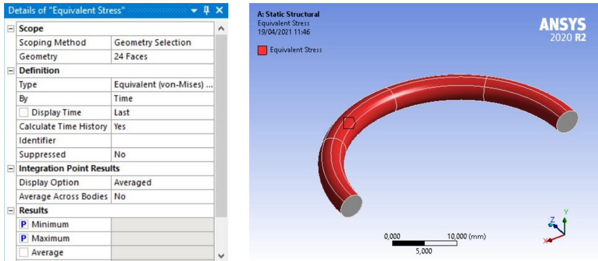
Figura 3.11: Tensioni sul mantello secondo il criterio di Von Mises
