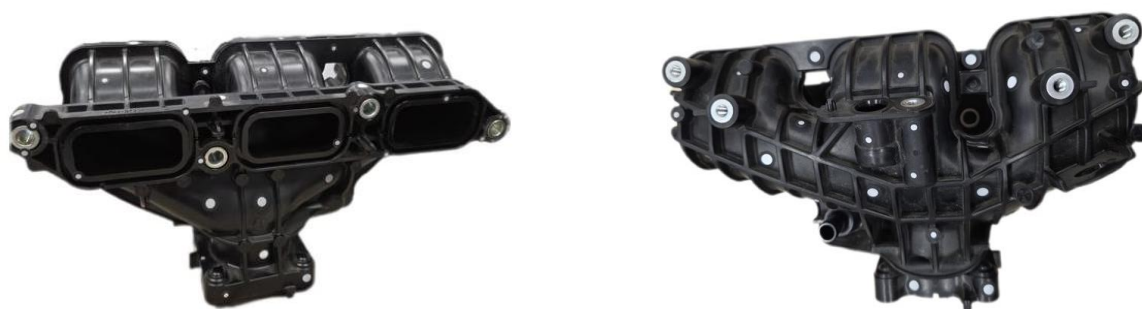
Figura 14 Collettore di aspirazione con marker applicati
