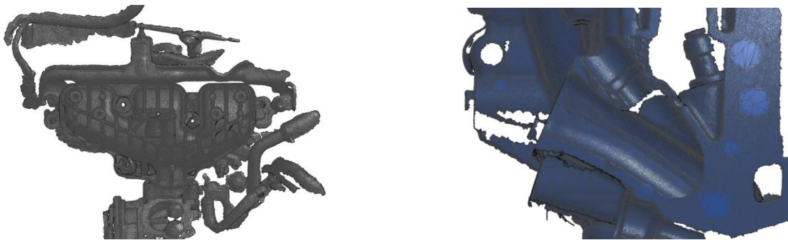
Figura 15 Scansioni del vano motore e condotto di aspirazione nella testata
