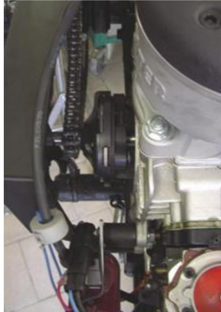
Figura 44: Particolare della frizione centrifuga
