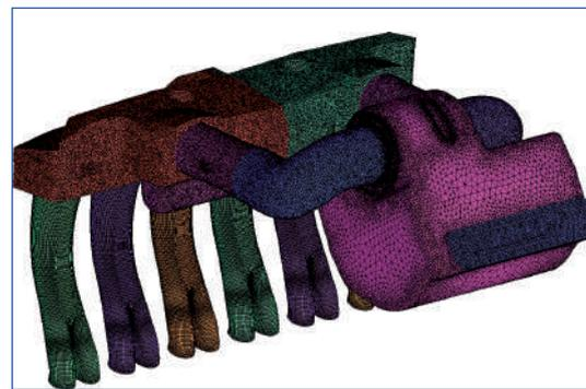
Figura 10 - Griglia completa assemblata.
